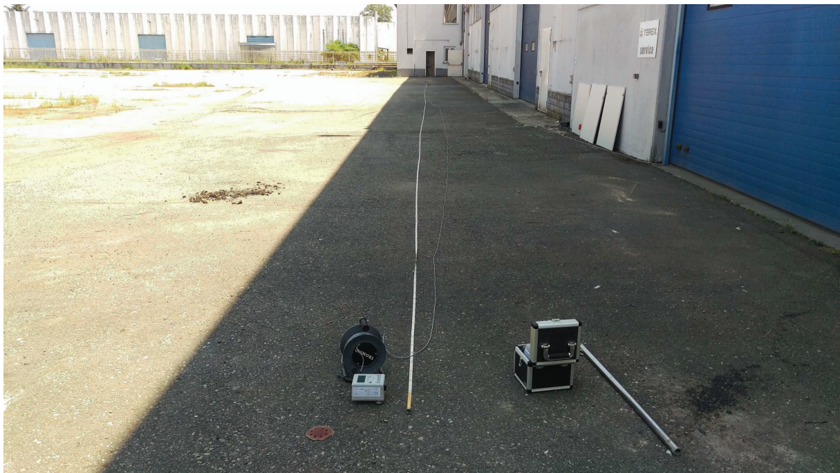
Esecuzione di misura di sismica attiva MASW
