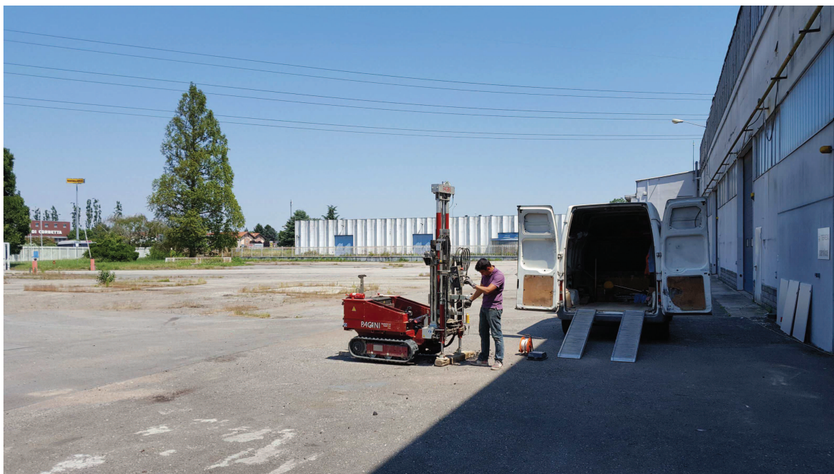
Esecuzione delle prove penetrometriche DPSH
