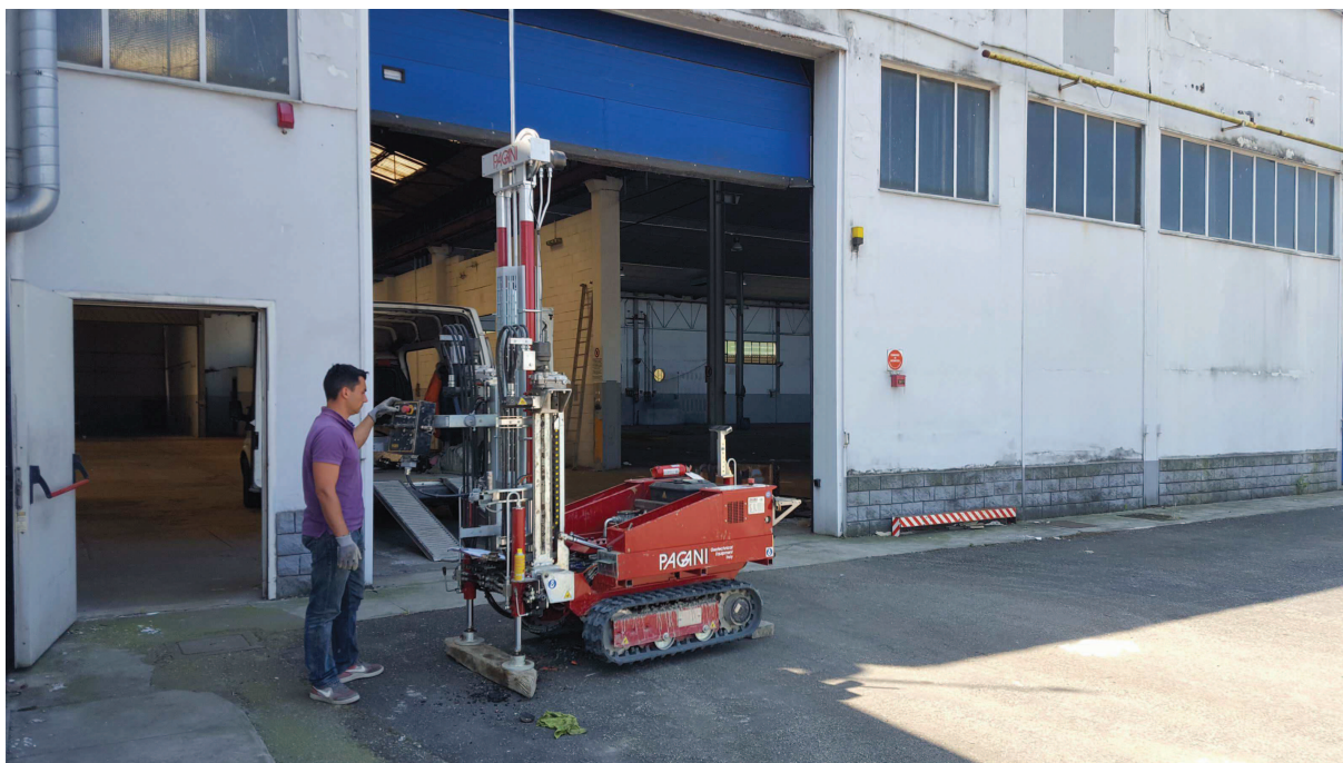
Esecuzione delle prove penetrometriche DPSH
